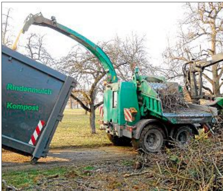
Aus Schnittgut werden in der Häckselmaschine Holzhackschnitzel.
